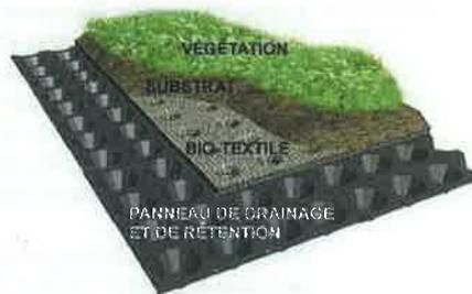
L'autre atout non négligeable de la toiture végétalisée découle de ses caractéristiques isolantes naturelles. L'isolation thermique ainsi obtenue permet de réaliser d'importantes économies d'énergies surtout l'été en terme de climatisation et de façon moindre en hiver en terme de chauffage.
