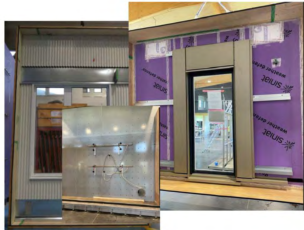
FACADES ET PERFORMANCES AEV Essais AEV en usine
